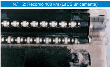
No se observa material extraño dentro de los canales.
