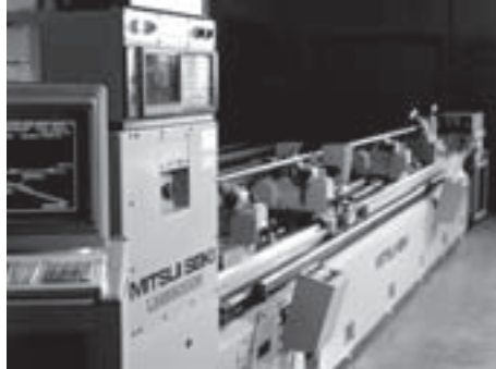
Máquina automática de medición de paso que usa láser
